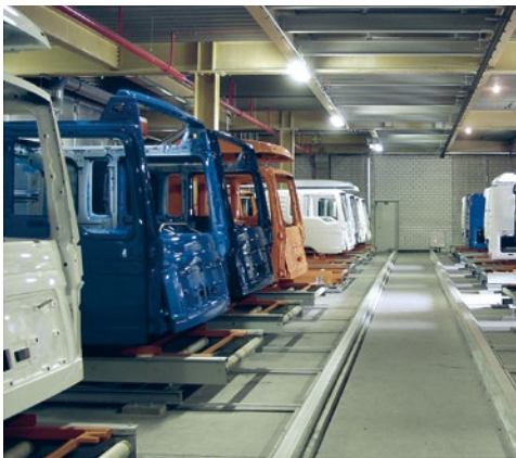
MAN AG, DACHAU MUNICH Production buffers
